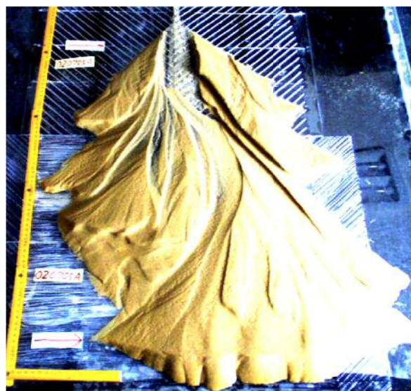
左は海水準上昇速度一定のもとで、右は海水準下降速度一定のもとでそれぞれモデル実験によって生成したデルタです。水位の変動はいずれも一定かつ連続的であるのに、デルタ上には不連続的な地形が必ず現れます。このような地形のことを自己組織的(self-organizing)と形容しますが、もしこういったモデル実験をしなければ、「海水準が段階的に変動した結果だ」といったような（よくありがちな）誤った解釈を導いてしまうのです。モデル実験の重要性がおわかりいただけるでしょう。
