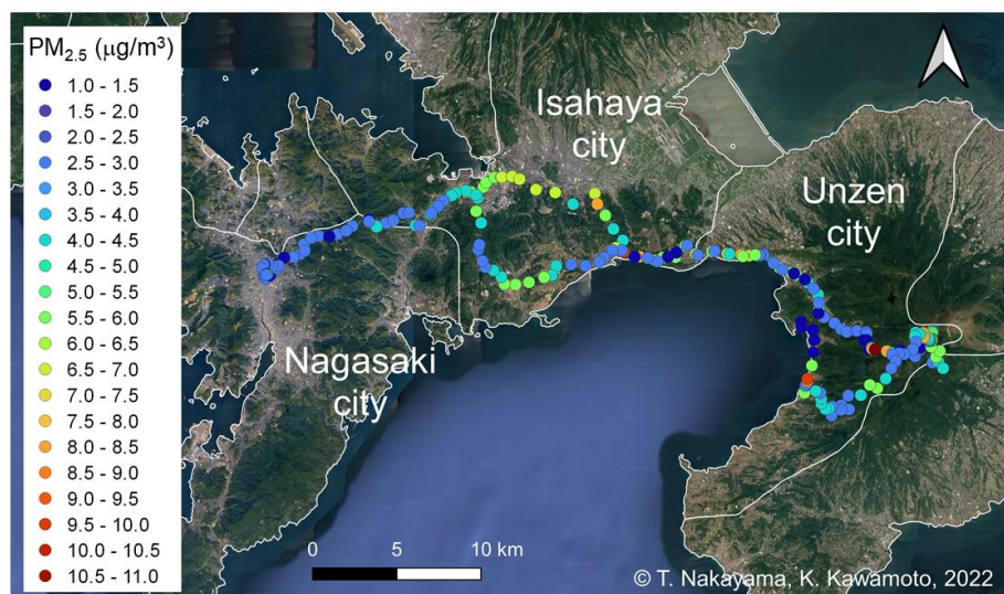
2022年10月22日にモバイル計測器で測定したPM 2.5 質量濃度の例
