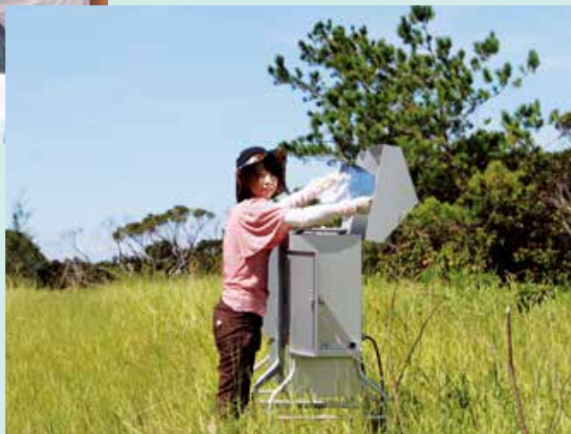
沖縄の山中で越境大気の捕集装置をセット
